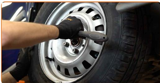
**29** Rimettere il veicolo per terra e, lavorando in ordine incrociato, serrare i bulloni di fissaggio delle ruote. Usa una chiave dinamometrica. Serralo fino allo coppia di torsione di 110 Nm.
