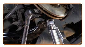
Avvita l'elemento di fissaggio anteriore del braccio. Utilizza una chiave a bussola N°18. Utilizza una chiave combinata N°18. Usa una chiave dinamometrica. Serralo fino allo coppia di torsione di 90 Nm. +75°
