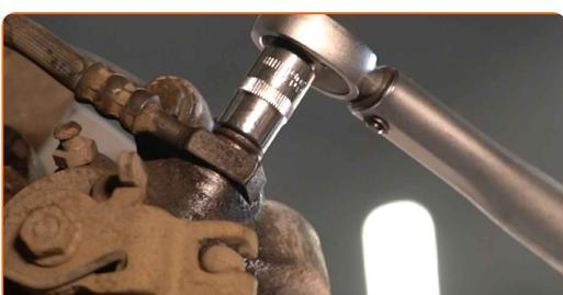
**26** Rimuovi la fascetta di fissaggio del tubo freni.
