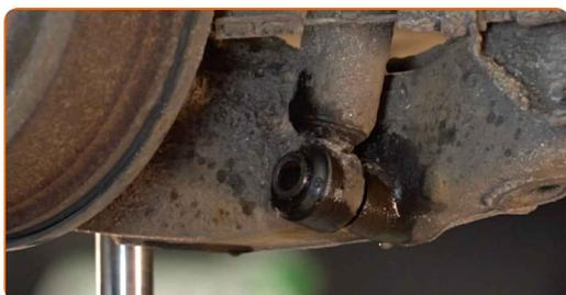
**10** Svita l'elemento di fissaggio superiore dell'ammortizzatore. Utilizza una chiave a bussola N°E20. Usa un giramaschi.
