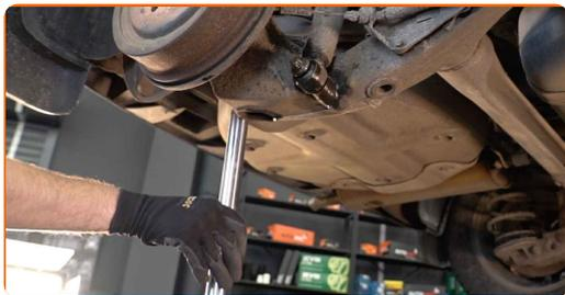
**8** Avvita l'elemento di fissaggio inferiore dell'ammortizzatore. Utilizza una chiave a bussola N°E20. Usa un giramaschi.
