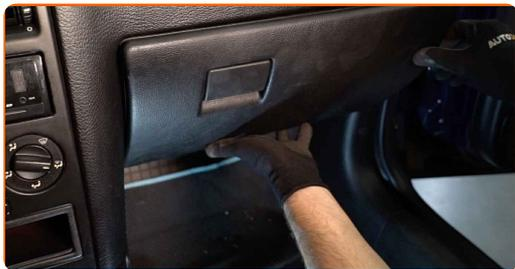
**15** Avvitare le viti di fissaggio del vano portaoggetti. Usa la chiave Torx T20.
