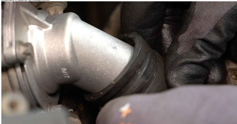
29 Fissare le fascette dei tubi del refrigerante. Usa le pinze per fascette Clic-R.
