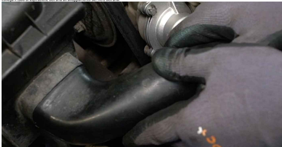
32 Fissare la clip sul tubo di aspirazione del filtro dell'aria.
