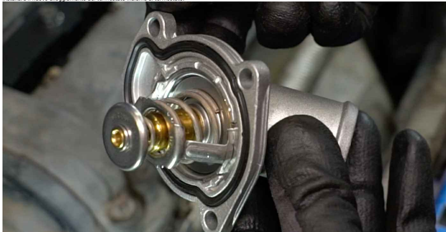
26 Installa la guarnizione adesiva in gomma.
