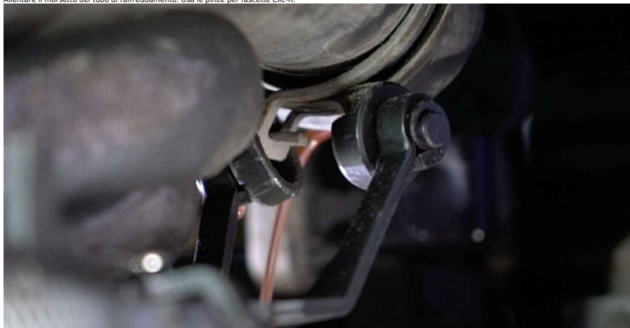
8 Staccare il tubo di raffreddamento.
