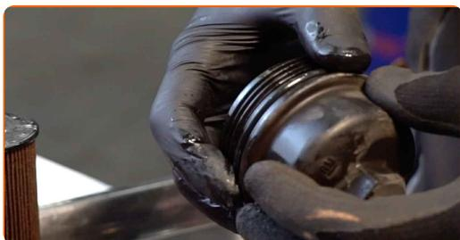
**19** Installa il nuovo filtro dell'olio alla sede di montaggio del coperchio del filtro.
