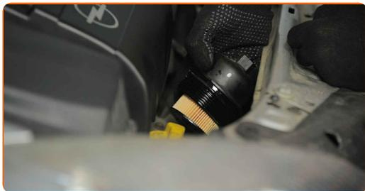
**21.2** Utilizza una chiave a bussola N°27. Usa una chiave dinamometrica. Serralo fino allo coppia di torsione di 25 Nm.
