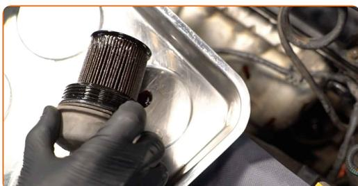
Sostituzione: olio motore e filtro - VAUXHALL Agila Mk II (B) (H08). Gli esperti di AUTODOC raccomandano:
