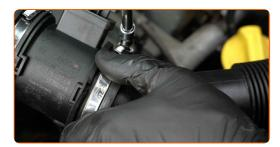
Avvita l'elemento di fissaggio del tubo della presa d'aria. Usa la chiave Torx T25.
