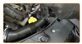
Scollega il collare di fissaggio del tubo di aspirazione. Utilizza una chiave a bussola N°7. Usa una chiave a cricchetto.
