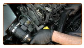
Fissa il collare di fissaggio al tubo di aspirazione. Utilizza una chiave a bussola N°7. Usa una chiave a cricchetto.
