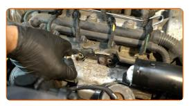
Stringere le candelette. Usa la chiave a bussola per candele numero 8. Usa una chiave dinamometrica. Serralo fino allo coppia di torsione di 10 Nm.
