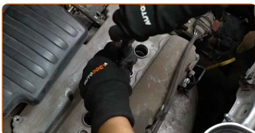
**22** Avvitare le nuove candele e serrarle. Usa la chiave a bussola per candele numero 16. Usa una chiave dinamometrica. Serralo fino allo coppia di torsione di 24 Nm.
