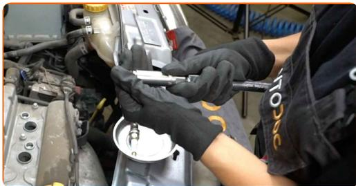
**20** Applica uno strato sottile dello speciale lubrificante antigrippaggio per alte temperature alle filettature delle candele nuove.
