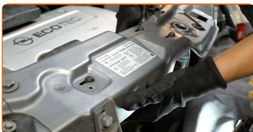
**35** Avvitare i dispositivi di fissaggio dell'alloggiamento del gruppo di distribuzione dell'aria. Usa la chiave Torx T20.
