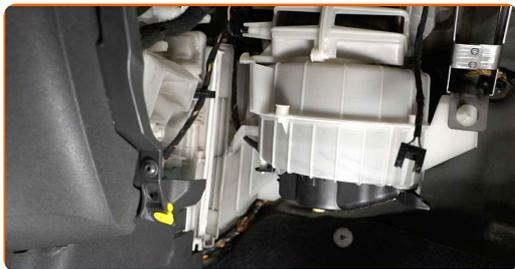
**13** Rimuovere dall'alloggiamento del filtro l'elemento filtrante da sostituire.
