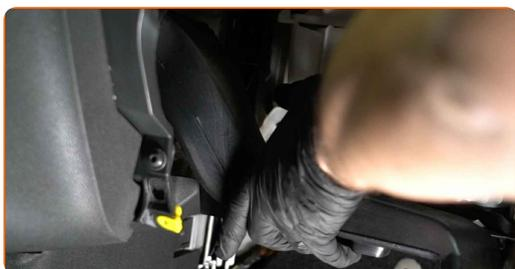
**17** Installa gli elementi di fissaggio dell'alloggiamento del condotto dell'aria.
