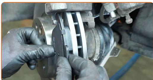
**19** Installare la pinza del freno e fissarla.
