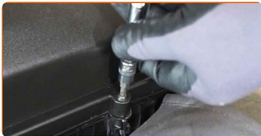
**13** Applicare un prodotto trattante sul connettore del sensore del flusso d'aria di massa. Usa il grasso al silicone.
