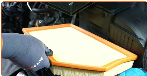
Sostituzione: filtro aria - Volvo V70 BW. AUTODOC raccomanda:
