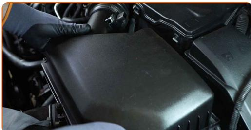
**12** Avvita le viti di serraggio sul coperchio del filtro dell'aria. Usa la chiave Torx T25. Usa una chiave a cricchetto.
