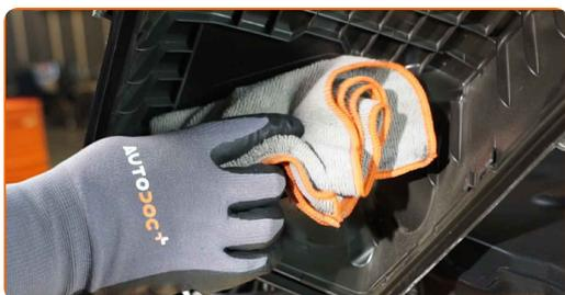
**7** Rimuovere l'elemento filtrante dall'alloggiamento del filtro.
