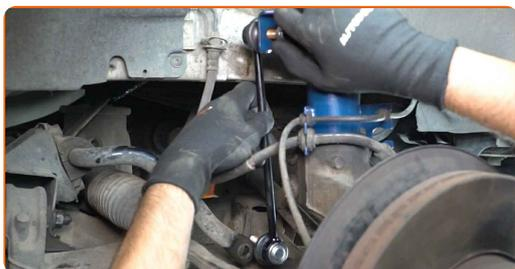
**13** Serra gli elementi di fissaggio che collegano il tirante della barra stabilizzatrice alla barra. Utilizza una chiave a bussola N°19. Usa una chiave dinamometrica. Serralo fino allo coppia di torsione di 60 Nm. +45°
