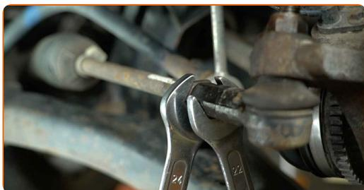
**9** Svitare il dado che collega la testina del tirante al fuso a snodo dello sterzo. Utilizzare una chiave a bussola da 22 mm. Utilizzare una chiave a cricchetto.
