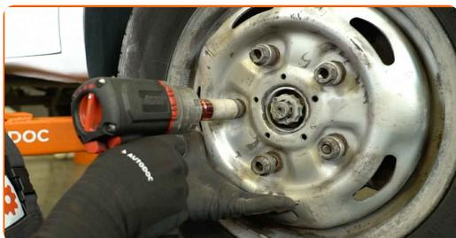
**22** Abbassare la vettura e serrare i dadi della ruota in modo incrociato. Utilizzare una chiave a bussola ad impatto per ruote da 21 mm. Utilizzare una chiave dinamometrica. Coppia di serraggio: 200 N·m.
