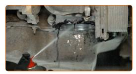
Installare il tappo del filtro dell'olio ed avvitarlo. Utilizzare una chiave a bussola da 30 mm. Utilizzare una chiave dinamometrica. Coppia di serraggio: 20 N·m.
