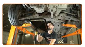
Pulire l'area del foro di scarico della coppa dell'olio. Utilizzare una spazzola metallica. Utilizzare uno spray detergente multiuso.
