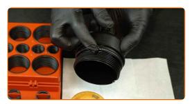
Installare un nuovo elemento filtrante nel tappo del filtro dell'olio.
