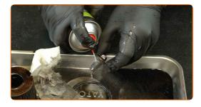
16 Installare un nuovo O-ring sul tappo di scarico.
