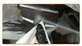
Avvitare il tappo di scarico e stringerlo. Utilizzare una chiave a bussola da 13 mm. Utilizzare una chiave dinamometrica. Coppia di serraggio: 23 N·m.
