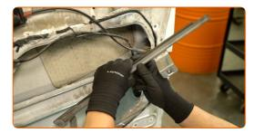
Svitare gli elementi di fissaggio della serratura della portiera. Utilizzare una punta Torx T30. Utilizzare un cacciavite elettrico o a cricchetto.
