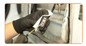
Fissare il cavo del blocco della portiera ad una nuova serratura della portiera.
