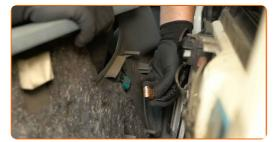
Sganciare l'asta di bloccaggio che collega la serratura alla maniglia esterna della portiera.
