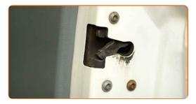
Svitare gli elementi di fissaggio del pannello della portiera. Utilizzare un cacciavite a croce Phillips.
