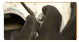
Serrare gli elementi di fissaggio del binario guida del finestrino. Utilizzare una chiave a bussola da 8 mm. Utilizzare una chiave dinamometrica. Coppia di serraggio: 10 N·m.
