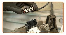
Staccare il cavo del blocco della portiera dalla serratura.
