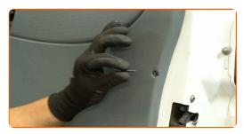
Staccare il pannello della portiera. Utilizzare uno strumento per la rimozione delle finiture in plastica.
