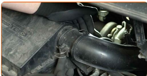
**4** Scollegare il tubo di aspirazione dell'aria dall'alloggiamento del filtro dell'aria.
