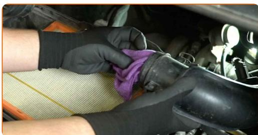
**8** Rimuovere l'elemento filtrante dall'alloggiamento del filtro.
