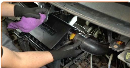
**14** Collegare il tubo di aspirazione dell'aria all'alloggiamento del filtro dell'aria.
