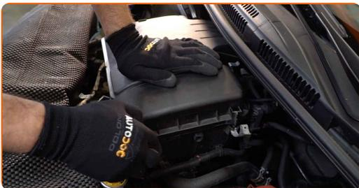
**15** Installa i morsetti di fissaggio del tubo di sfiato del filtro dell'aria e del tubo flessibile d'ingresso. Usa le pinze per fascette stringitubo con un fermo.
