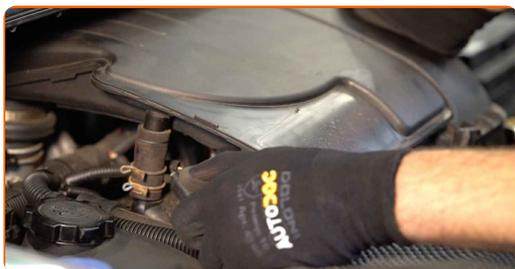
**6** Scollega il tubo di aspirazione dell'aria dall'alloggiamento del filtro dell'aria.
