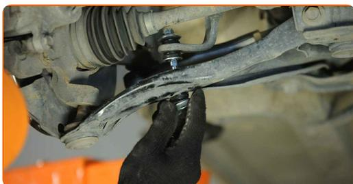
**17.1** Serra l'elemento di fissaggio che collega la barra stabilizzatrice con il braccio di sospensione.
