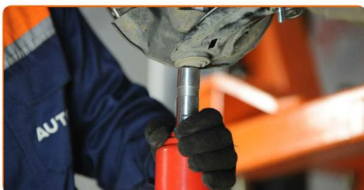
**16** Serra gli elementi di fissaggio che collegano il tirante della barra stabilizzatrice alla barra. Utilizza una chiave combinata N°13. Utilizza una chiave a bussola N°13. Usa una chiave dinamometrica. Serralo fino allo coppia di torsione di 18 Nm.
