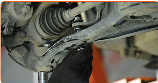
**17.2** Utilizza una chiave combinata N°13. Utilizza una chiave a bussola N°13. Usa una chiave dinamometrica. Serralo fino allo coppia di torsione di 18 Nm.
