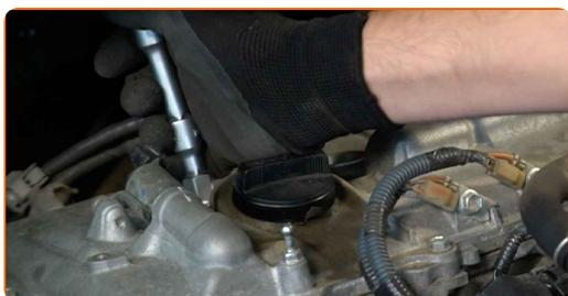
**13** Avvitare le nuove candele e serrarle. Usa la chiave a bussola per candele numero 16. Usa una chiave dinamometrica. Serralo fino allo coppia di torsione di 20 Nm.
