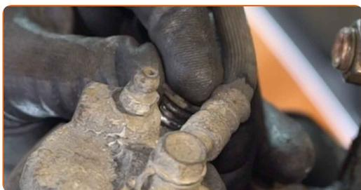
**32** Installare la molla di fissaggio della pinza freno. Usa un piede di porco.
