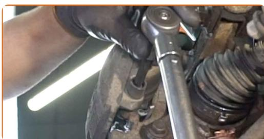
**31** Montare i tappi dei parapolvere delle guide pinza freno.
