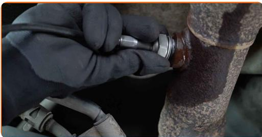
**10** Stringere l'elemento di fissaggio del sensore di ossigeno. Utilizza una chiave combinata N°22. Usa una chiave dinamometrica. Serralo fino allo coppia di torsione di 41 Nm.
