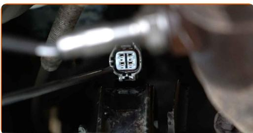
**12** Collegare il connettore del sensore di ossigeno.
