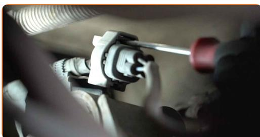
**3** Pulire l'elemento di fissaggio del sensore di ossigeno. Usa una spazzola metallica. Usa lo spray WD-40.
