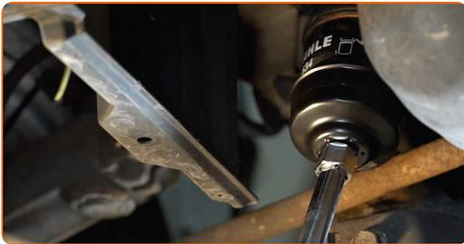
10 Prepara un contenitore per il filtro dell'olio vecchio. Metti il vecchio filtro dell'olio nel contenitore.
