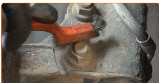
**29** Svitare gli elementi di fissaggio che collegano il puntone di sospensione al fuso a snodo dello sterzo. Utilizza una chiave combinata N°19. Utilizza una chiave a bussola N°19. Usa una chiave a cricchetto.
