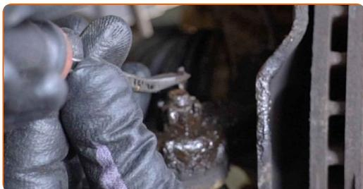
**11** Svitare il dado di attacco del gambo al fuso a snodo. Utilizza una chiave a bussola N°17. Usa una chiave a cricchetto.
