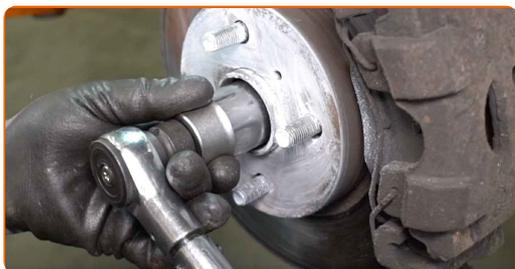
**77** Riacciacca l'elemento di fissaggio dell'albero di trasmissione. Usa uno scalpello piatto per la lavorazione dei metalli. Usa un martello.
