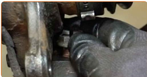
**54** Avvita l'elemento di fissaggio che collega il puntone dell'ammortizzatore al fuso a snodo. Utilizza una chiave combinata N°19. Utilizza una chiave a bussola N°19. Usa una chiave a cricchetto.
