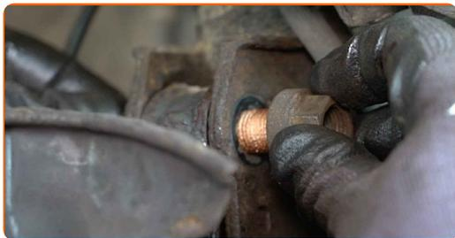
**51** Installare il fuso a snodo dello sterzo sull'assale CV.
