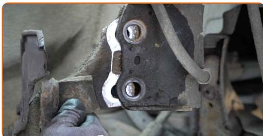
**33** Rimuovere il fuso a snodo dello sterzo insieme al mozzo della ruota.
