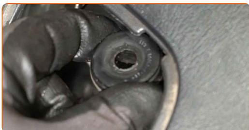
**16** Rimuovere il supporto da sotto il fuso a snodo posteriore.
