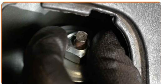
**26** Rimuovere il supporto da sotto il fuso a snodo posteriore.
