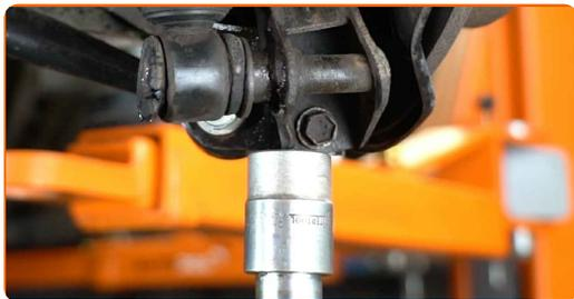
**14** Svita l'elemento di fissaggio superiore dell'ammortizzatore.
