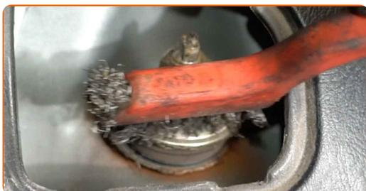
**4** Allenta l'elemento di fissaggio superiore dall'ammortizzatore. Utilizza una chiave combinata N°14 (2 pezzi).
