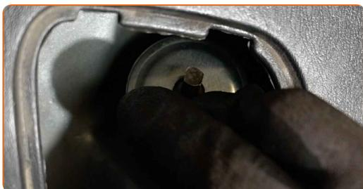
**25** Avvita gli elementi di fissaggio superiori dell'ammortizzatore.
