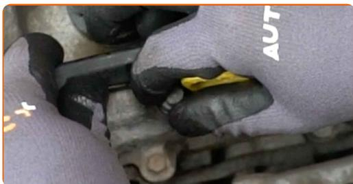
**32** Serrare gli elementi di fissaggio del supporto del cablaggio. Utilizza una chiave a bussola N°10. Usa una chiave dinamometrica. Serralo fino allo coppia di torsione di 9 Nm.
