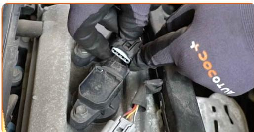
**14** Scollega gli elementi di fissaggio della bobina di accensione. Utilizza una chiave a bussola N°10. Usa una chiave a cricchetto.
