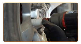
Rimettere il veicolo per terra e, lavorando in ordine incrociato, serrare i bulloni di fissaggio delle ruote. Usa una chiave dinamometrica. Serralo fino allo coppia di torsione di 112 Nm.
