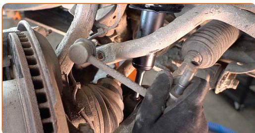
Sostituzione: biellette barra stabilizzatrice - TOYOTA HILUX III Pick-up (TGN1\_, GGN2\_, GGN1\_, KUN2\_, KUN1\_). Il consiglio degli esperti di AUTODOC:
