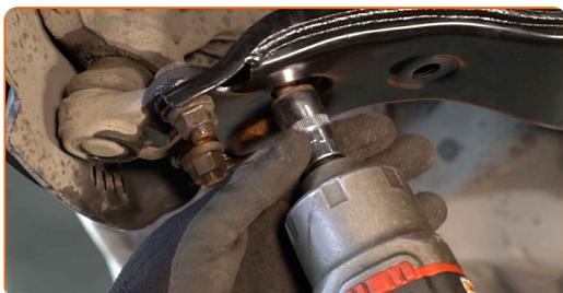
**29** Installa l'elemento di fissaggio posteriore del braccio.
