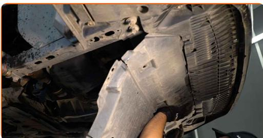
**39** Serra gli elementi di fissaggio del coperchio inferiore della coppa dell'olio. Utilizza una chiave a bussola N°10. Usa una chiave a cricchetto. Usa uno strumento per estrazione clip.
