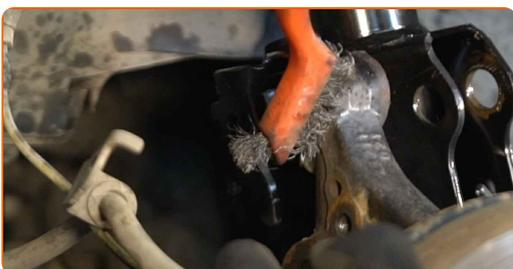
**42** Fissare il supporto di ammortizzazione sul fuso a snodo.
