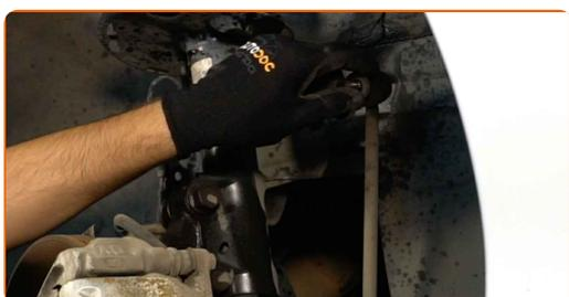
Sostituzione: ammortizzatore a molla - TOYOTA COROLLA Tre volumi (E15\_).
