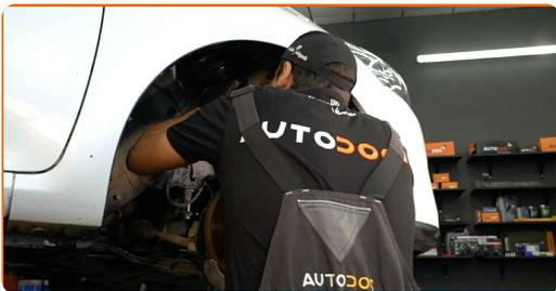
**40** Avvita l'elemento di fissaggio superiore del montante supporto ammortizzazione. Non lo serrare.
