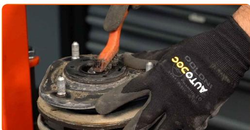
**25** Rimuovere il dado del montante del supporto di ammortizzazione. Utilizza una chiave a catena. Utilizza una chiave a bussola N°21. Usa una chiave a cricchetto.
