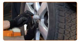
Rimettere il veicolo per terra e, lavorando in ordine incrociato, serrare i bulloni di fissaggio delle ruote. Usa una chiave dinamometrica. Serralo fino allo coppia di torsione di 103 Nm.
