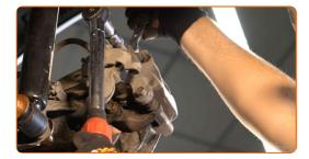
Installa il cavo del freno di stazionamento nella staffa della pinza del freno.
