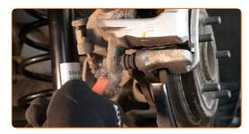
Scollega il cavo del freno a mano dalla staffa sulla pinza freno. Usa le pinze per pompa ad acqua.
