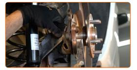
Collega il connettore del sensore di velocità ABS.
