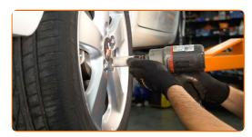
Rimettere il veicolo per terra e, lavorando in ordine incrociato, serrare i bulloni di fissaggio delle ruote. Usa la chiave a bussola per dadi cerchio ruota n.21. Usa una chiave dinamometrica. Serralo fino allo coppia di torsione di 103 Nm.
