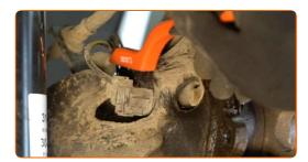
Scollega il connettore del sensore di velocità ABS. Usa un giravite piatto.
