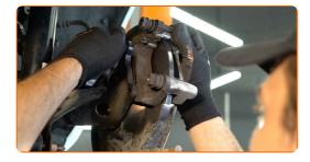
Serrare il sostegno pinza freno. Utilizza una chiave a bussola N°14. Usa una chiave dinamometrica. Serralo fino allo coppia di torsione di 57 Nm.
