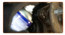
Pulisci il connettore del sensore di velocità ABS. Usa un detergente spray multiuso.
