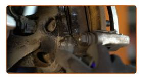
Svitare l'attacco della staffa pinza freno. Utilizza una chiave a bussola N°14. Usa un giramaschi. Usa una chiave a cricchetto.
