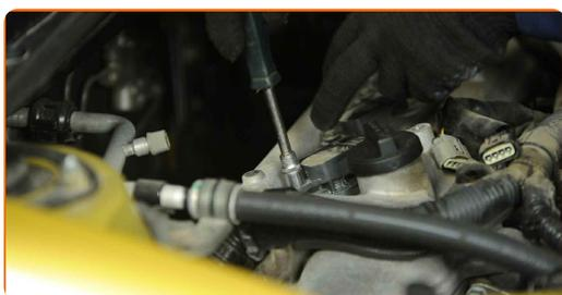
**16** Tratta il connettore delle bobine di accensione con uno spray per dispositivi elettronici. Lo spray proteggerà i contatti elettrici dalla corrosione, l'ossidazione e la resistenza di contatto.
