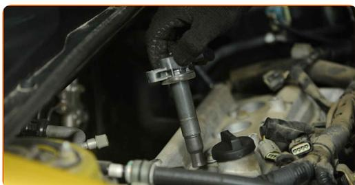
**15** Serra gli elementi di fissaggio delle bobine di accensione. Utilizza una chiave a bussola N°10. Usa una chiave a cricchetto.
