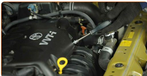
**4** Rimuovere la copertura del motore.
