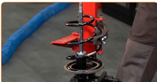
**37** Installa il nuovo supporto, il parapolvere e il tampone dell'ammortizzatore.
