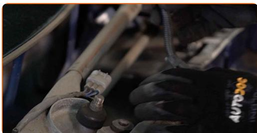
**8** Svita gli elementi di fissaggio del pannello della tiranteria del tergicristallo. Utilizza una chiave a bussola N°10. Usa una chiave a cricchetto.
