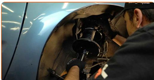
44 Avvita l'elemento di fissaggio superiore del montante supporto ammortizzazione. Non lo serrare.
