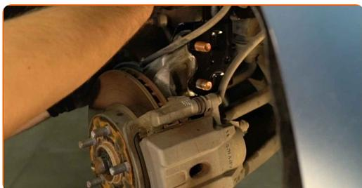
**48** Rimuovi il supporto da sotto il fuso a snodo.
