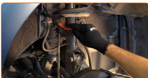
**18** Scollegare il cablaggio e il tubo flessibile freno dalla staffa del supporto di ammortizzazione. Utilizza una chiave a bussola N°12. Usa una chiave a cricchetto.
