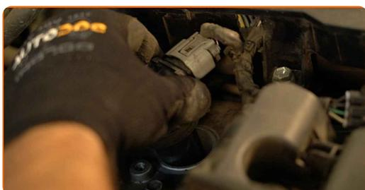
Sostituzione: candele di accensione - TOYOTA CELICA Cabriolet (AT20\_, ST20\_). AUTODOC raccomanda:
