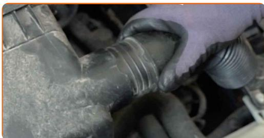
**36** Montare il coperchio del filtro d'aria. Fissarlo.
