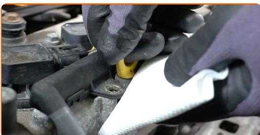
**11** Spostare la staffa del cablaggio da una parte.
