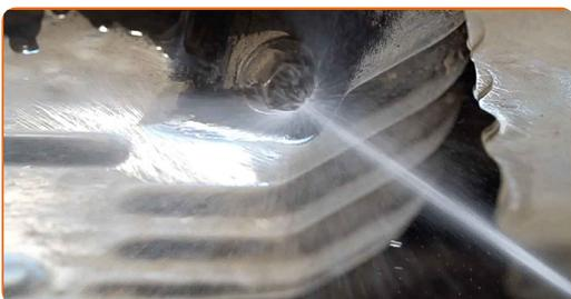
**8** Poni un contenitore per gli oli esausti di una capacità di almeno 5 litri al di sotto del foro di drenaggio.
