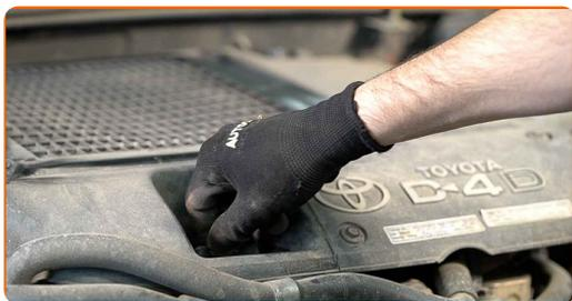
**24** Far funzionare il motore per qualche minuto. Dopo che la spia di segnalazione luminosa della pressione dell'olio sarà spenta, spegni il motore.
