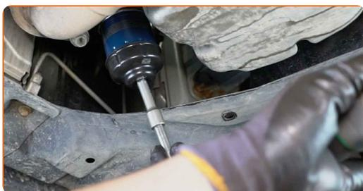
Sostituzione: olio motore e filtro - TOYOTA Aygo X (AB70). Il consiglio di AUTODOC:
