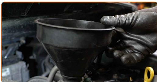
**23** Versa l'olio nel motore attraverso serbatoio. Quantità di olio richiesta:3.2 l.
