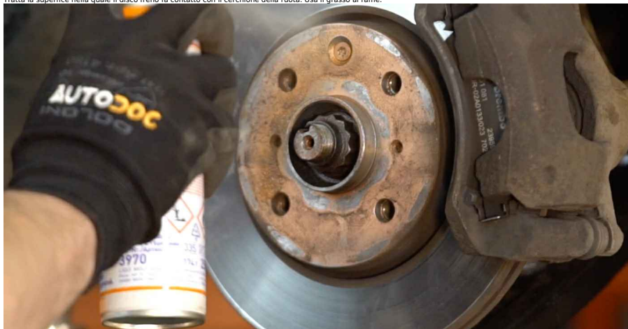
23 Pulisci la sede di montaggio dei cerchioni della ruota. Usa un pulitore freni.
