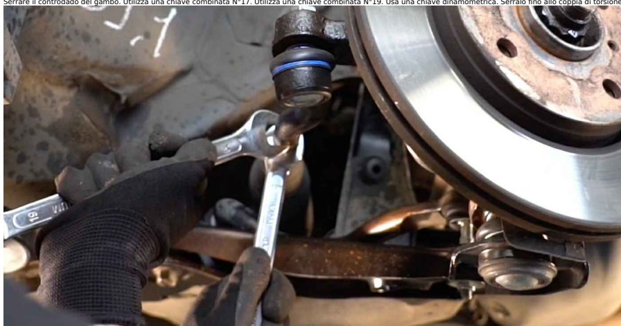
20 Installare il semicono che fissa il perno di montaggio della testa barra comando sterzo. club.auto-doc.it 7-11
