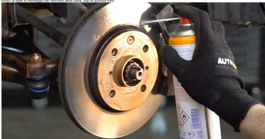
23 Pulisci la sede di montaggio dei cerchioni della ruota. Usa un pulitore freni.
