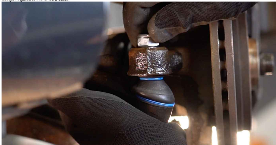
18 Serra il bullone di fissaggio che collega la testina tirante al fuso a snodo. Utilizza una chiave a bussola N°17. Usa una chiave dinamometrica. Serralo fino allo coppia di torsione di 33 Nm.
