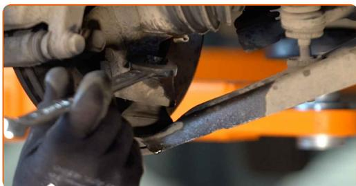
20 Puntellare il fuso a snodo. Usa un cric idraulico per trasmissione.
