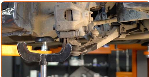
21 Scollegare il braccio inferiore dal fuso a snodo. Usa un estrattore del giunto sferico. Usa un piede di porco.
