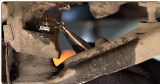
19 Svitare il perno che fissa il giunto sferico al fuso a snodo. Utilizza una chiave combinata N°19.
