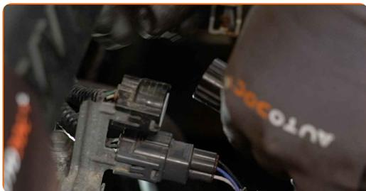
**4** Allentare il morsetto per liberare il cablaggio del sensore di ossigeno (sonda lambda). Usa un giravite piatto.
