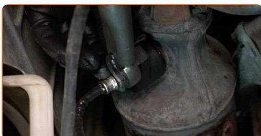
**23** Applicare un prodotto trattante sul connettore del sensore di ossigeno. Usa il grasso al silicone.
