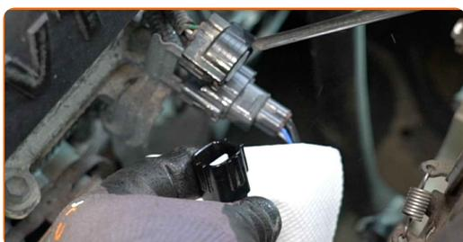
**24** Collegare il connettore del sensore di ossigeno.
