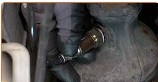
**22** Stringere l'elemento di fissaggio del sensore di ossigeno. Utilizzare una presa per sensore di ossigeno da 22 mm. Usa una chiave dinamometrica. Serralo fino alla coppia di torsione di 40 Nm.
