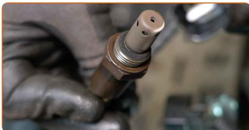
**8** Tagliare il filo per il nuovo sensore di ossigeno. Utilizzare un maschio per filettatura. Usa una chiave a cricchetto.
