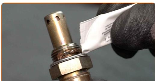
**21** Installare il nuovo sensore di ossigeno.
