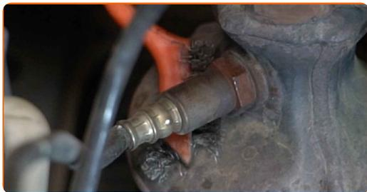
**6** Svitare l'elemento di fissaggio del sensore di ossigeno. Utilizzare una chiave poligonale aperta #22. Usa una chiave a cricchetto.
