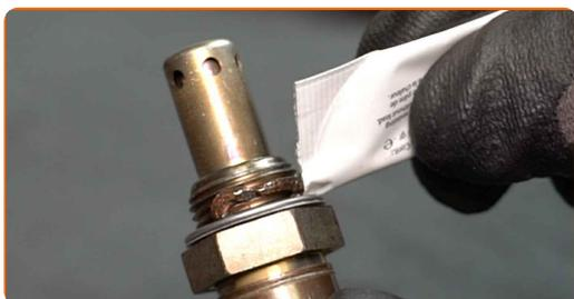
**21** Installare il nuovo sensore di ossigeno.
