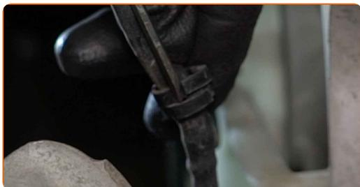
**5** Pulire l'elemento di fissaggio del sensore di ossigeno. Usa una spazzola metallica. Usa lo spray WD-40.
