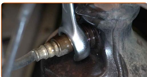
**7** Rimuovere il sensore di ossigeno (sonda lambda).
