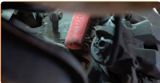
**14** Svitare l'attacco della staffa pinza freno. Utilizza una chiave a bussola N°17. Usa un giramaschi.
