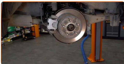
**9** Svita gli elementi di fissaggio che collegano l'albero di trasmissione al mozzo della ruota. Utilizza una chiave a bussola N°30. Usa un giramaschi.
