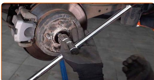
**10** Tratta con del prodotto le scanalature dell'albero di trasmissione del giunto omocinetico. Usa lo spray WD-40.
