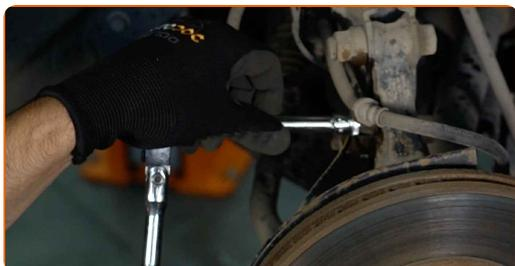
**12** Pulisci gli elementi di fissaggio che collegano il puntone dell'ammortizzatore al fuso a snodo. Usa una spazzola metallica. Usa lo spray WD-40.
