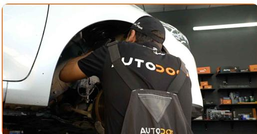
**38** Avvita l'elemento di fissaggio superiore del montante supporto ammortizzazione. Non lo serrare.
