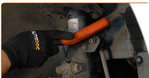
**11** Scollegare il cablaggio e il tubo flessibile freno dalla staffa del supporto di ammortizzazione. Utilizza una chiave a bussola N°14. Usa una chiave a cricchetto.
