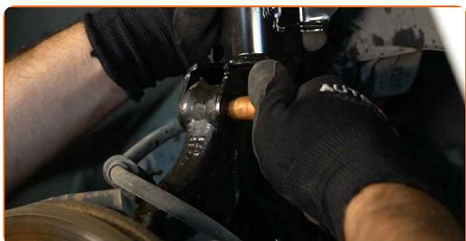
**42** Avvita l'elemento di fissaggio che collega il puntone dell'ammortizzatore al fuso a snodo. Utilizza una chiave combinata N°22. Utilizza una chiave a bussola N°22.
