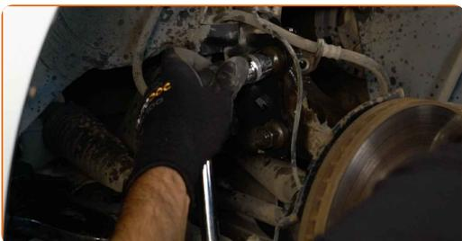
**16** Puntellare il fuso a snodo. Usa un cric idraulico per trasmissione.
