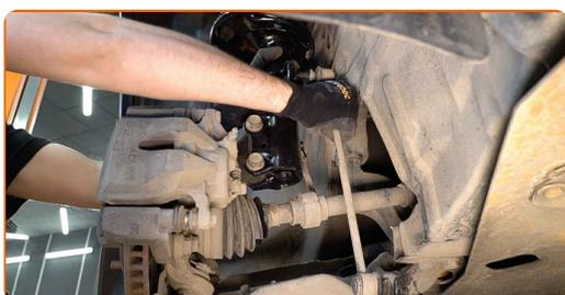
Sostituzione: biellette barra stabilizzatrice - TOYOTA AURIS (NZE18\_, ZRE18\_).
