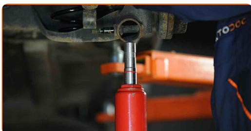
**17** Collega la parte inferiore dell'ammortizzatore.
