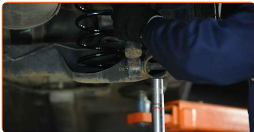
**18** Stringi l'elemento di fissaggio inferiore dell'ammortizzatore. Utilizza una chiave a bussola N°17. Usa una chiave dinamometrica. Serralo fino allo coppia di torsione di 90 Nm.
