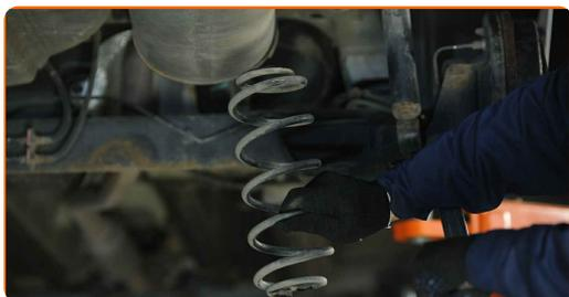
**13** Pulisci le sedi di montaggio della molla elicoidale. Usa una spazzola metallica. Usa lo spray WD-40.
