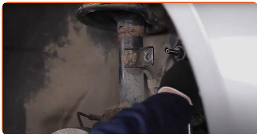
**9** Scollegare il cablaggio del sensore ABS. Usa un giravite piatto.
