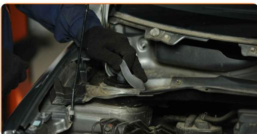
**24** Pulisci gli elementi di fissaggio del supporto superiore del puntone dell'ammortizzatore. Usa una spazzola metallica. Usa lo spray WD-40.
