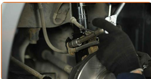
**55** Collegare il cablaggio del sensore ABS.
