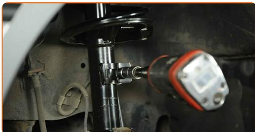
**58** Tratta con del prodotto gli elementi di fissaggio del puntone dell'ammortizzatore. Tratta con del prodotto tutti i giunti della barra stabilizzatrice. Usa il grasso al rame.
