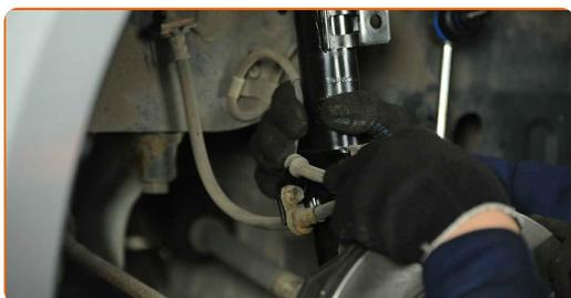
**56** Installa il puntone stabilizzatore trasversale.
