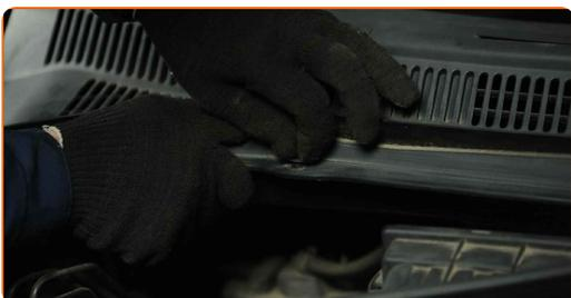
**47** Rimuovi la copertura di protezione del parafrango.
