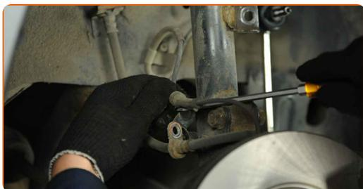
**13** Pulisci gli elementi di fissaggio che collegano il puntone dell'ammortizzatore al fuso a snodo. Usa una spazzola metallica. Usa lo spray WD-40.
