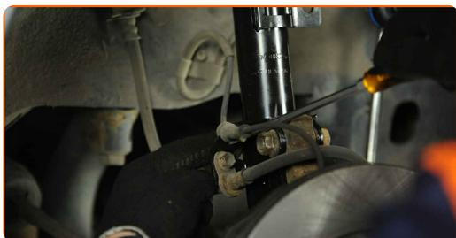
**10** Pulisci l'elemento di fissaggio della staffa che collega il tubo flessibile del freno al puntone dell'ammortizzatore. Usa una spazzola metallica. Usa lo spray WD-40.
