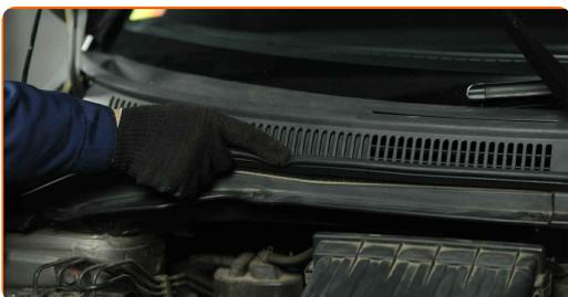
**46** Installa gli elementi di fissaggio della griglia sottoparabrezza di plastica.
