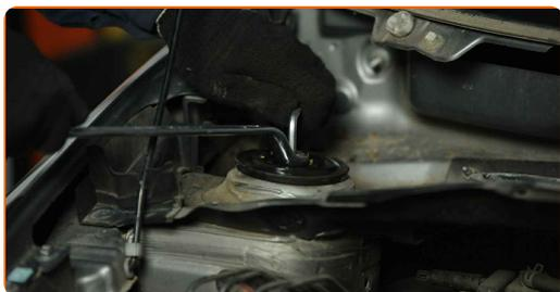
**43** Installare il coperchio di protezione della barra antiolio.
