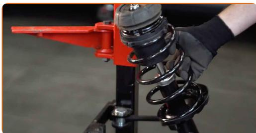
**40** Installare il supporto di ammortizzazione nell'arco passaruota.
