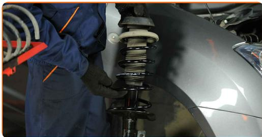
**41** Avvita l'elemento di fissaggio superiore del montante supporto ammortizzazione.
