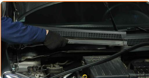
**45** Installa la guarnizione griglia sottoparabrezza.
