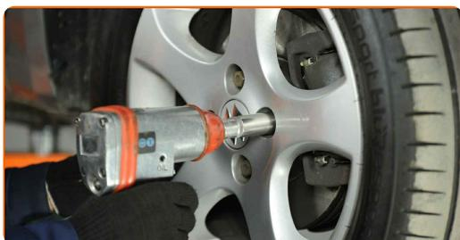
**63** Rimettere il veicolo per terra e, lavorando in ordine incrociato, serrare i bulloni di fissaggio delle ruote. Usa la chiave a bussola per dadi cerchio ruota n.21. Usa una chiave dinamometrica. Serralo fino allo coppia di torsione di 85 Nm.
