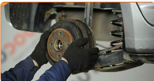
**17** Serrare l'attacco del mozzo. Utilizza una chiave a bussola N°30. Usa una chiave dinamometrica. Serralo fino allo coppia di torsione di 175 Nm.
