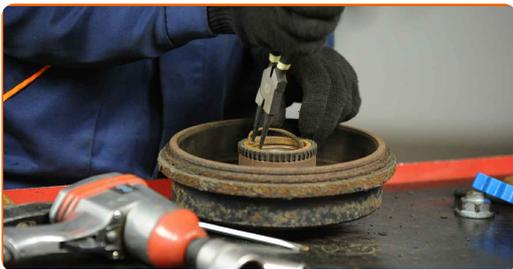
**16** Monta il freno a tamburo assemblato con il cuscinetto del mozzo ruota.
